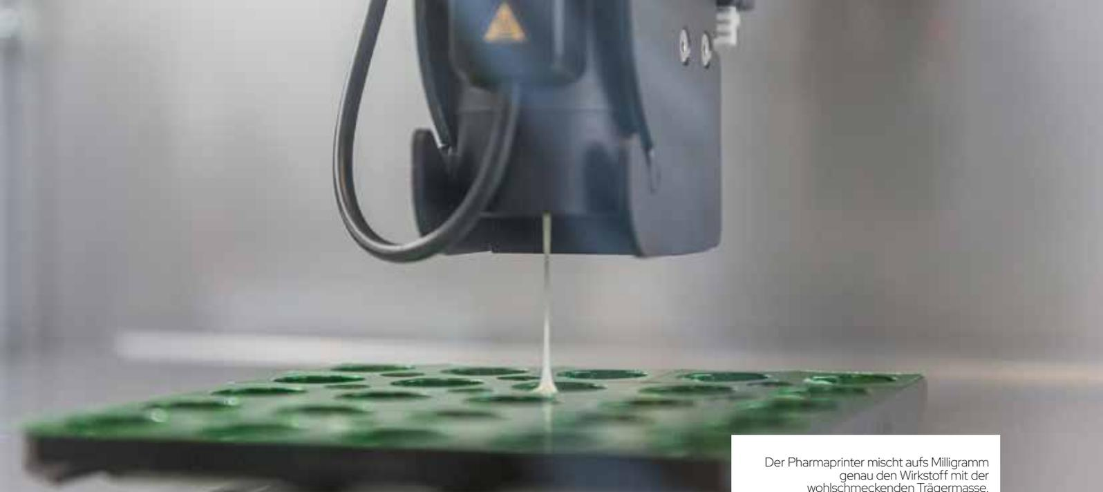
Der Pharmaprinter mischt aufs Milligramm genau den Wirkstoff mit der wohlschmeckenden Trägermasse.
